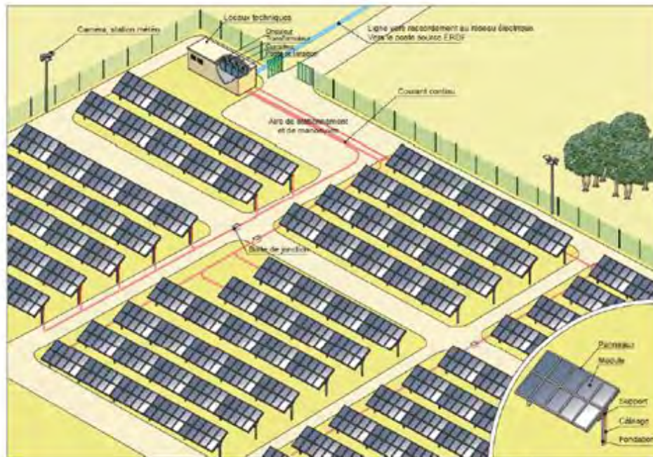
Schéma de principe d'un parc PV au sol (Guide de l'étude d'impact - MEDOTL - Avril 2011)
