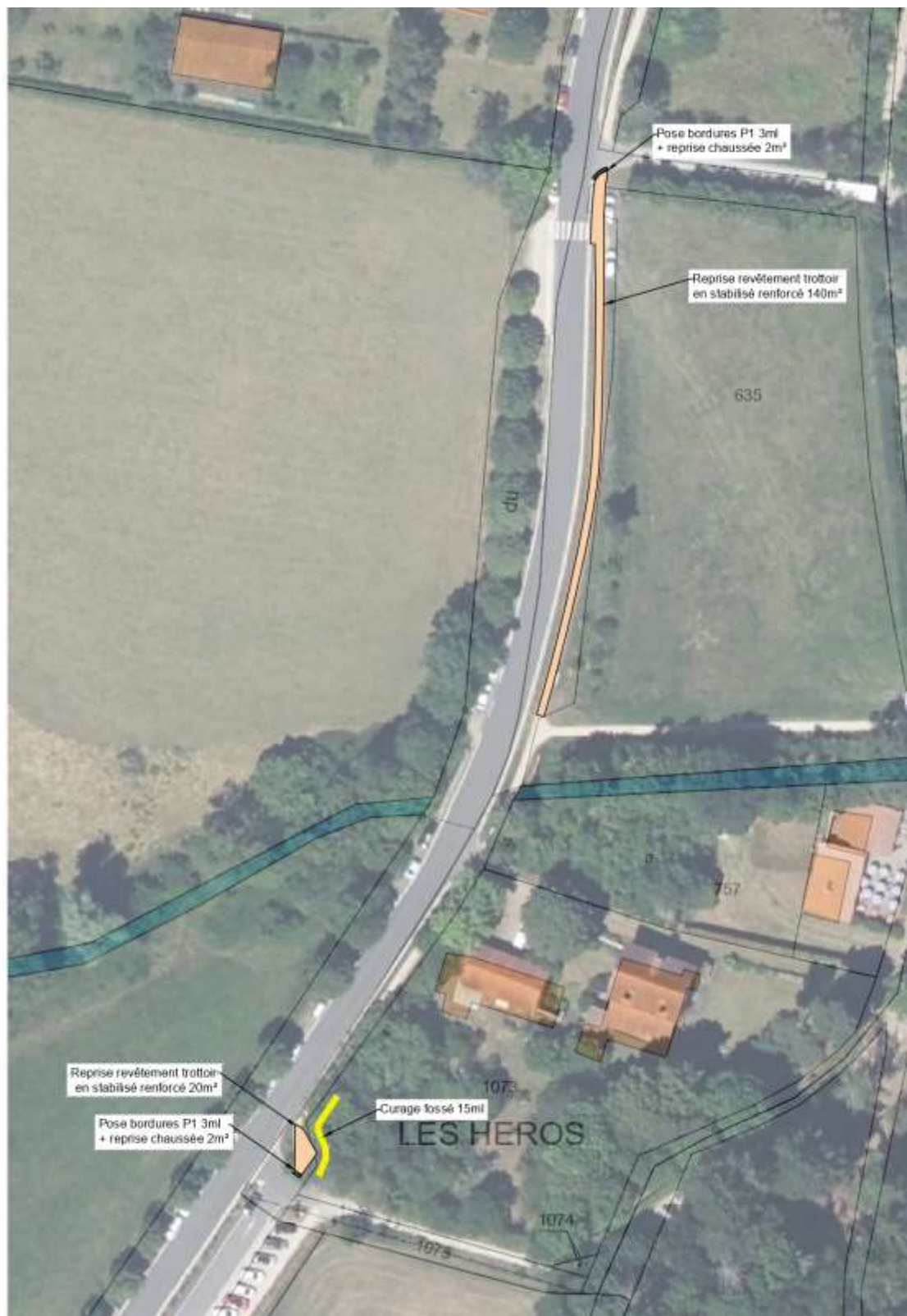
Reprise du trottoir entre le parking Nord et le parking Sud
